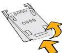
Снимите заднюю крышку, закрывающую отсек для SIM-карты.
