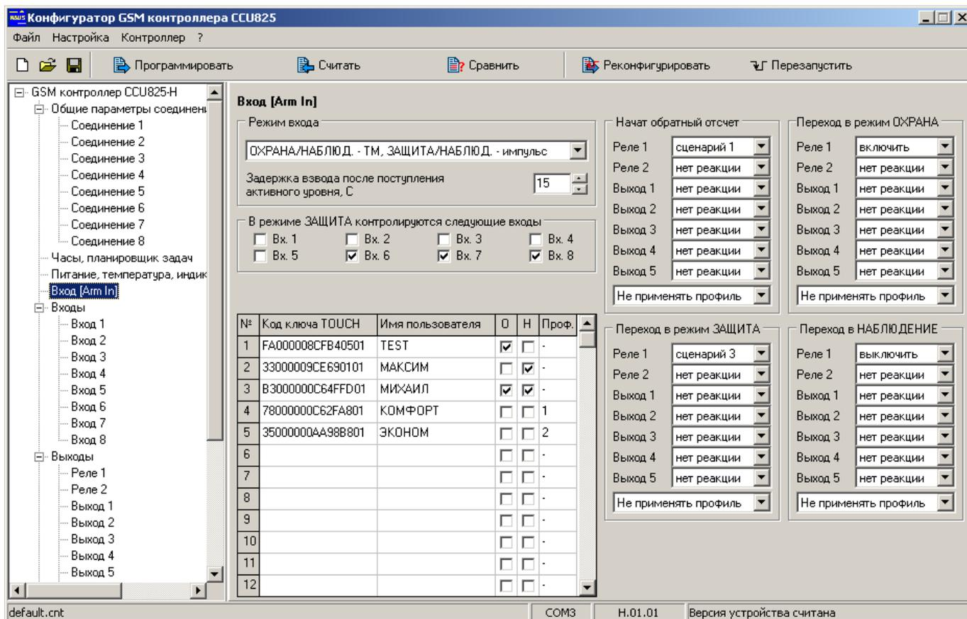
Рисунок 6. Настройка параметров входа [Arm In]
