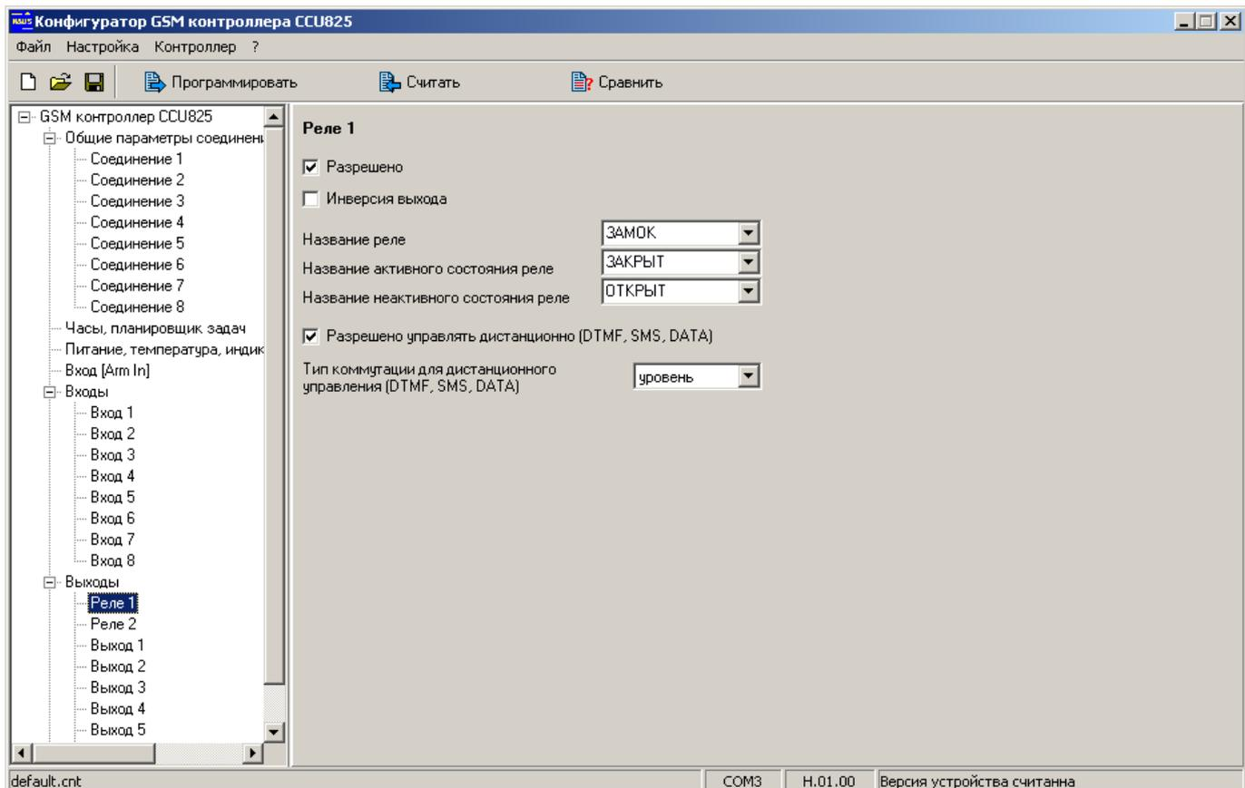
Рисунок 1. Типовая настройка параметров выходов
