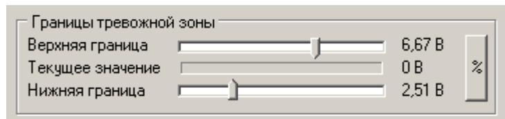
Внимательный пользователь скорее всего заметил, что при таком включении не контролируется короткое замыкание шлейфа. Т.е. значение на входе 0В считается нормальным, а оно будет присутствовать когда датчик неактивен и когда
