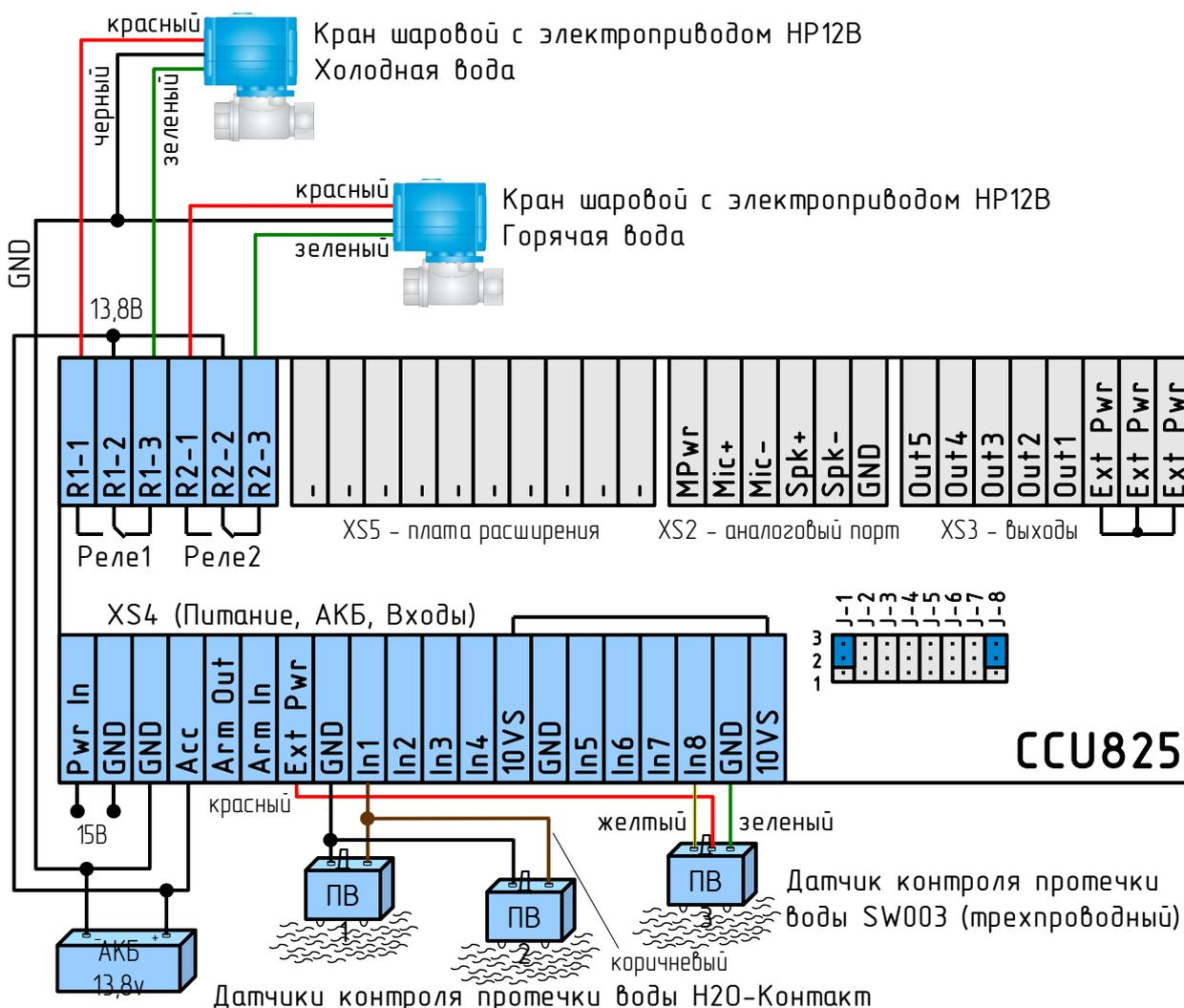
Рисунок 1. Пример организации системы предотвращения протечки воды с оповещением владельца по телефону
