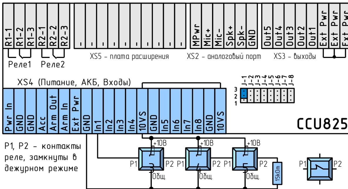
Рисунок 3. Подключение активных датчиков
