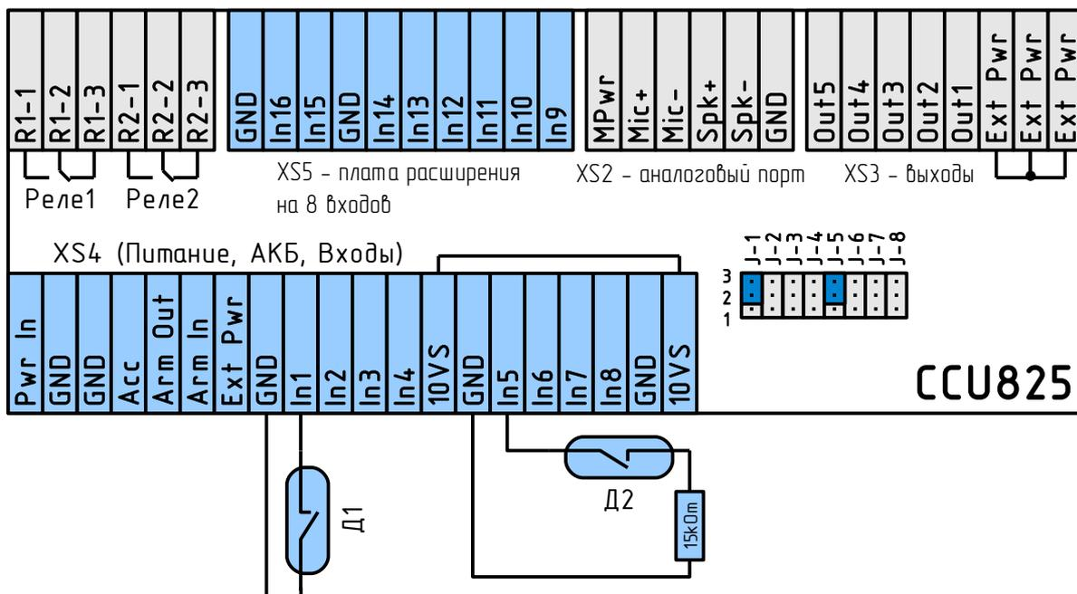
Рисунок 2. Подключение пассивных датчиков
