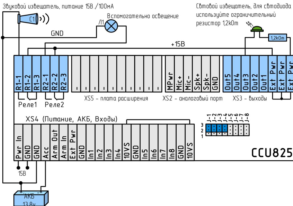
Рисунок 5. Подключение нагрузки к реле и выходу
