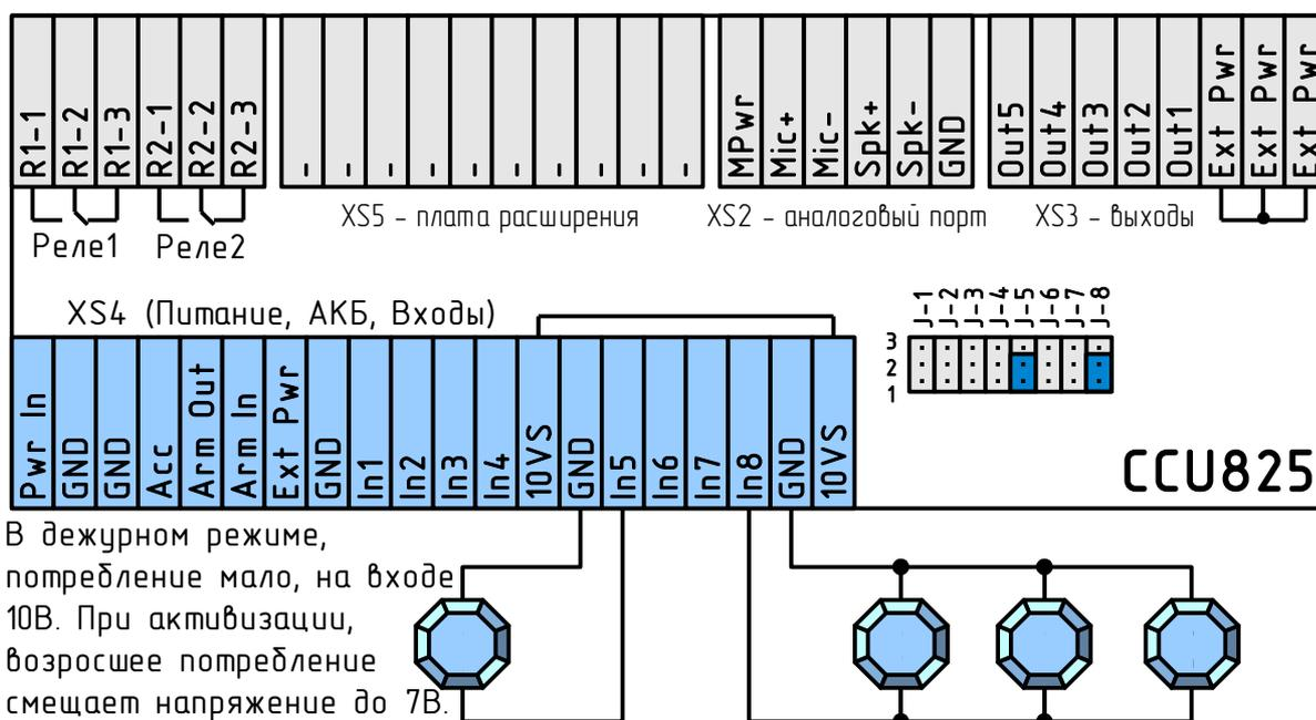
Рисунок 4. Подключение датчиков с питанием по шлейфу
