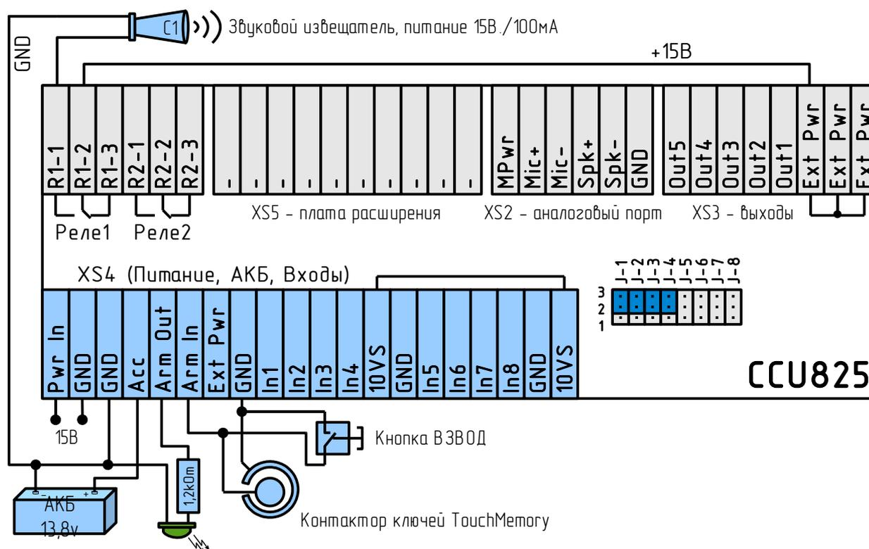
Рисунок 2. Подключение светодиода режима, контактора TouchMemory, кнопки ВЗВОД
